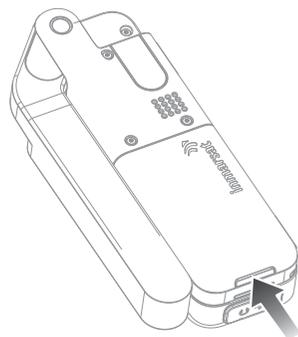
1 Извлеките аккумулятор. Для этого нажмите на защелку, поднимите и выньте аккумулятор.
